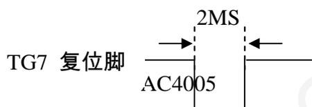
触发一次一个声音, mcu 低电平 TG6 发出几个脉冲识别第几个声音, 但在每次发出脉冲之前, 必须个给 otpTG7 复位
